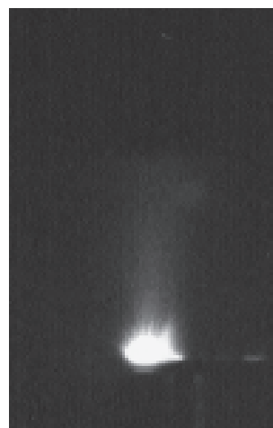
図8 真空中で発生させたブルームの写真.
