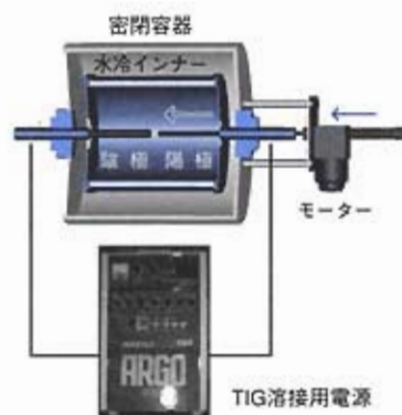
(b) カーボンナノ材料合成用アーク装置
