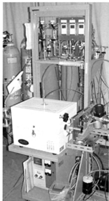
図3 減圧触媒CVD装置
